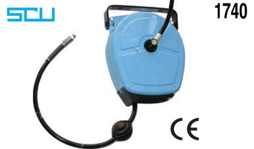
Tipo industriale, chiuso, solo per aria, in lamiera d'acciaio stampata e verniciata con polvere epossidica per la massima protezione. Avvolgimento automatico del tubo con possibilità di fermarlo alla lunghezza desiderata. Supporto a muro girevole per un ottimale orientamento. Tubo in poliuretano rinforzato con treccia tessile per una pressione d'uso fino a 20 bar, lunghezza m 12, Ø mm 8/12. Attacco entrata aria G. 3/8 F, attacco uscita aria G. 1/4 M. Peso kg 6.
