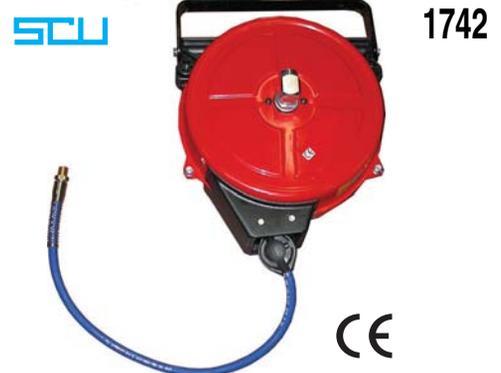
Tipo industriale, aperto, per aria e acqua, in lamiera d'acciaio stampata e verniciata con polvere epossidica per la massima protezione. Avvolgimento automatico del tubo con possibilità di fermarlo alla lunghezza desiderata. Supporto fisso a muro. Tubo in gomma speciale per una pressione d'uso fino a 18 bar, lunghezza m 15, Ø mm 8/14. Attacco entrata aria G. 3/8 F, attacco uscita aria G. 3/8 M. Peso kg 17. Senza supporto orientabile.
