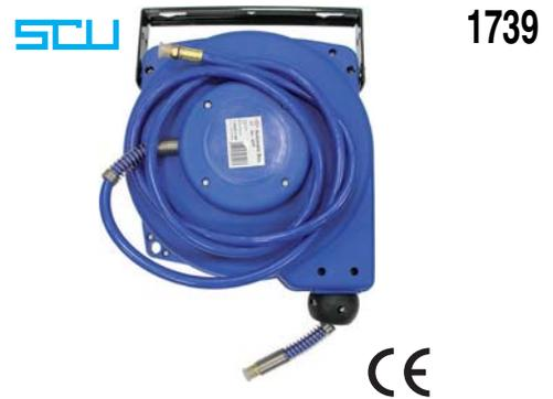
Tipo professionale, chiuso, solo per aria, in lamiera d'acciaio stampata e verniciata con polvere epossidica per la massima protezione. Avvolgimento automatico del tubo con possibilità di fermarlo alla lunghezza desiderata. Supporto a muro girevole per un ottimale orientamento. Tubo in poliuretano rinforzato con treccia tessile per una pressione d'uso fino a 20 bar, lunghezza m 5, Ø mm 8/11. Attacco entrata aria G. 3/8 F, attacco uscita aria G. 1/4 M. Peso kg 3.
